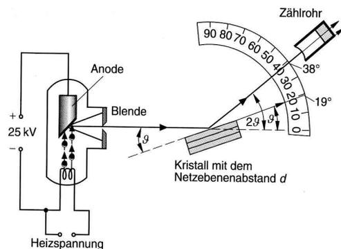
2. Man läßt des Röntgenlicht auf ein Kristall fallen. Diese wirkt wie ein Gitter. An diesem wird das Röntgenlicht spektral zerlegt: siehe auch Zeichnung oben.
